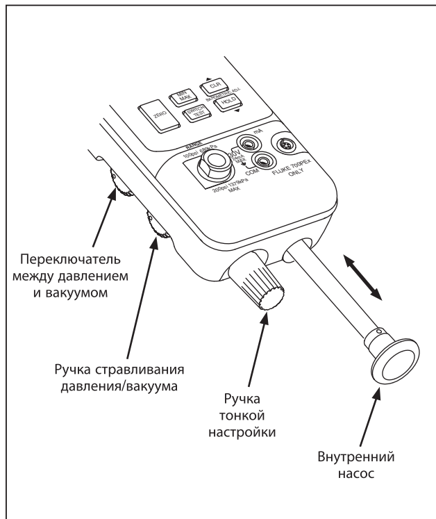
Рисунок 3. Элементы насоса
